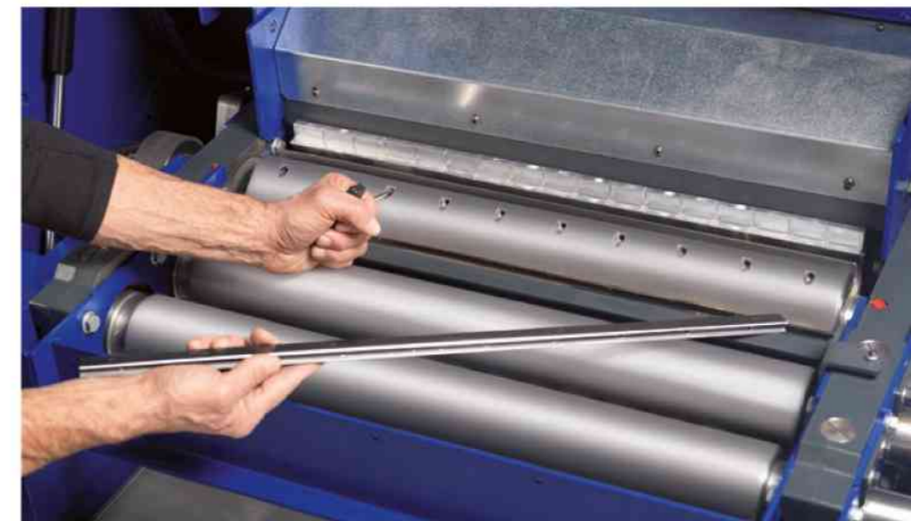
フェルダー替え刃式 4枚刃カッターブロック 記録的な速さで刃物交換が可能
