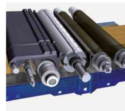
優れた艶仕上げ 分割プレッシャーバーとゴム製の投入・出口 ローラーによる仕上げ
