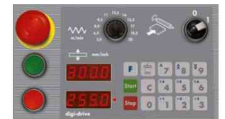
デジドライブ プレーナーテーブルの昇降コント ローラー
