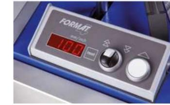
“X-モーション”では、軸昇降、傾斜、フェンスまでCNC制御
