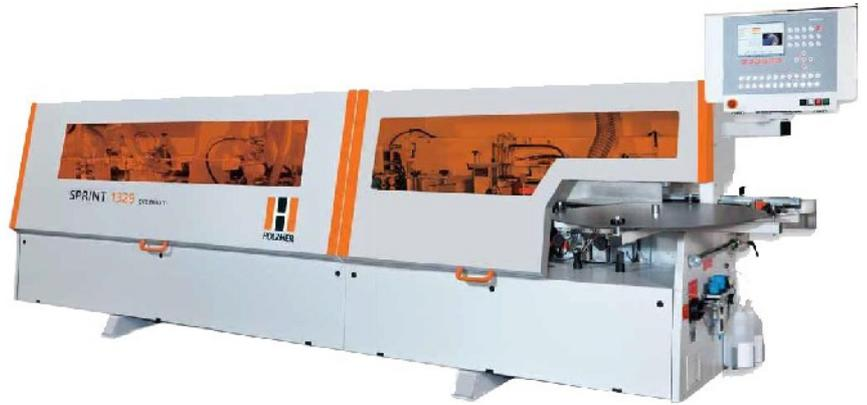
セット換えの多くをサーボモーター等電動、プログラム化し、簡単に、短時間にセット換えのできる、大変汎用性の高い機械です。
